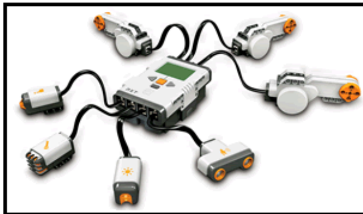
Figura 2.5 Sensores y Motores del Lego Mindstorms.
