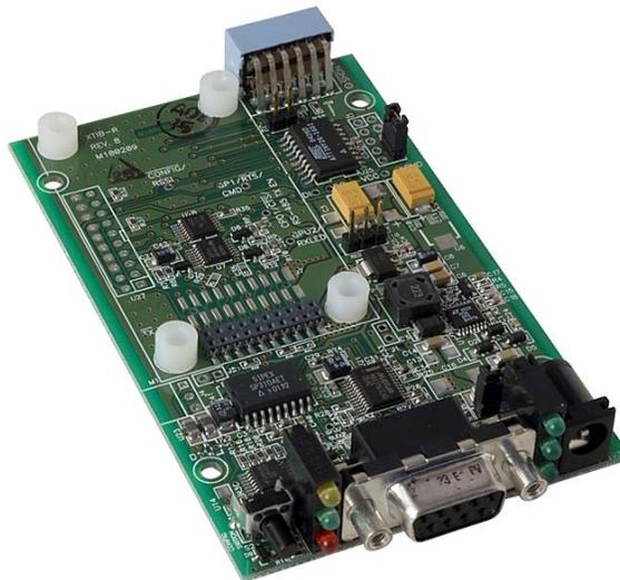
Fig. 3.9. Tarjeta MaxStream RS232 – Interfaz para la Radio
