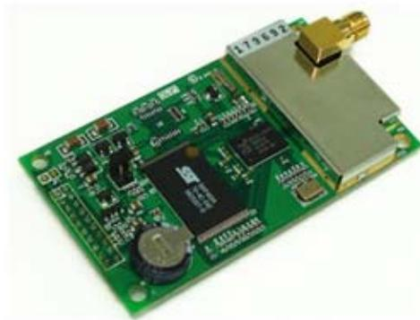
Fig. 2.5. Vista superior del GPS PG – 11
