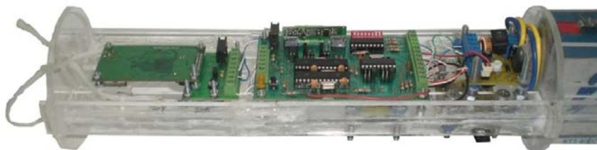
Fig. 4.7. Ensamblaje de la componente electrónica en el esqueleto de acrílico
