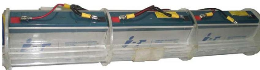
Fig. 4.8. Ensamblaje de las baterías en el esqueleto de acrílico
