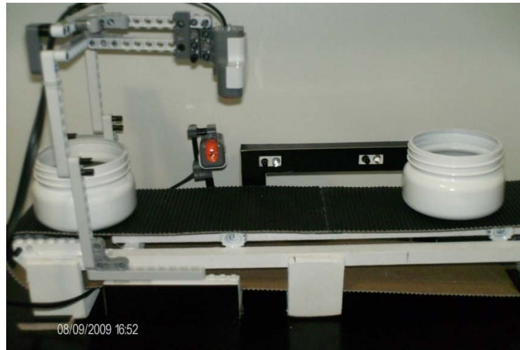
Fig. 4.1.3 Sensores de luz de en la banda transportadora
