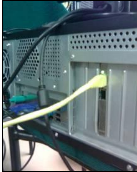
Figura 5.2 Color verde encendido en la tarjeta TE205P
