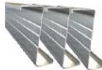
Gracias su geometría, es un perfil que posee gran inercia alrededor de sus ejes principales, y al estar conformada en acero galvanizado de mayor fluencia (ASTM 653 40 Ksi), nos permite obtener una alta capacidad de carga.
