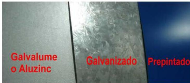
**FIGURA 1 TIPOS DE RECUBRIMIENTOS DE MATERIA PRIMA**
