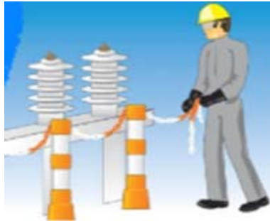
Fig. 5.10. Señalización y delimitación de la zona de trabajo.
