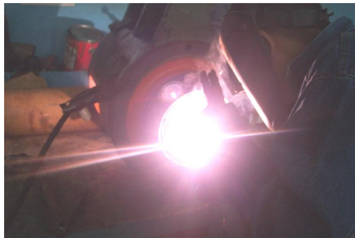
Figura. 13 - Recuperación de placas soldadas mediante soldadura
