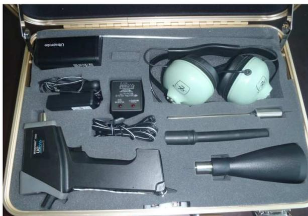
**FIG. 3.3 DETECTOR ULTRASÓNICO DE FUGAS**
