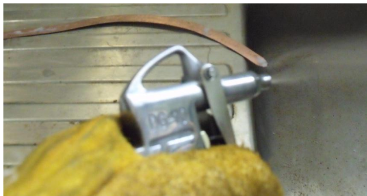
Figura 2.3. Aplicación del vapor mediante rociador.
