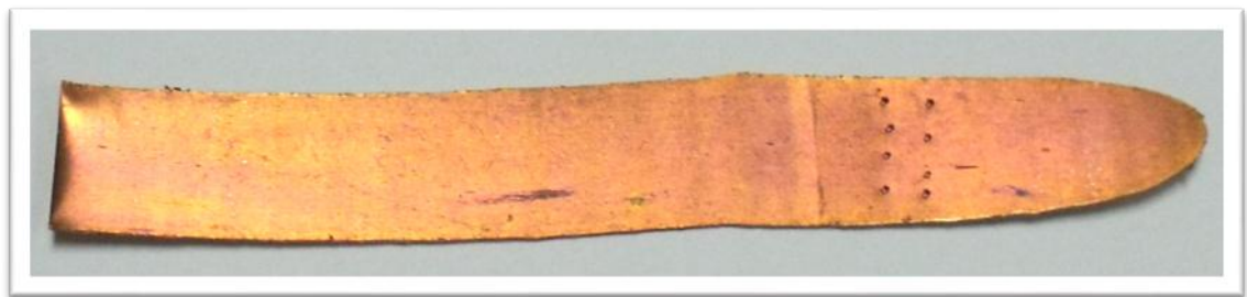
Figura 2.7. Prueba 9.4, limpieza de la lámina de cobre con ocho pases de vapor.
