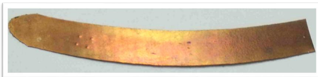
Figura 2.5. Prueba 9.2, limpieza de la lámina de cobre con cuatro pases de vapor.
