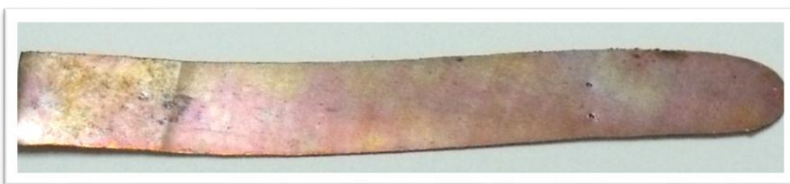
Figura 2.4. Prueba 9.1, limpieza de la lámina de cobre con dos pases de vapor.
