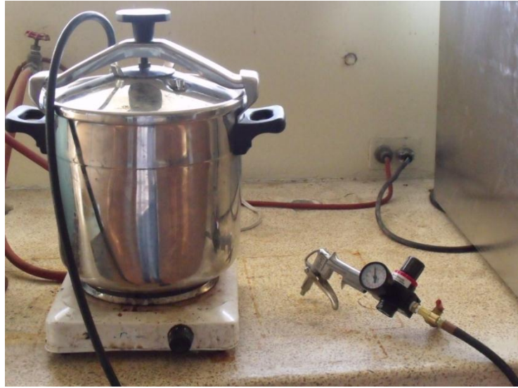
Figura 2.2. Conjunto: recipiente de presión, manguera, manómetro y pistola.
