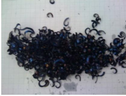
Figura 3. Tipo de Viruta inserto 4225
