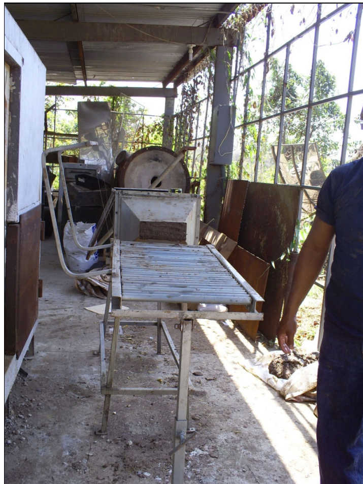
FIGURA 5.3. EXTRUSION DE LADRILLOS CON PROTOTIPO
