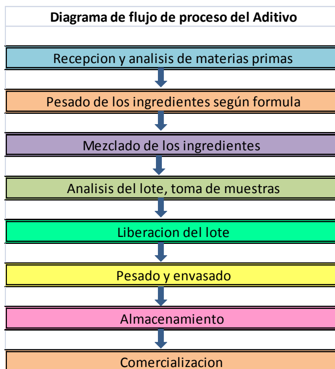
Figura 4.7 Diagrama flujo elaboración aditivo Fuente: C. Benavides, 2011
