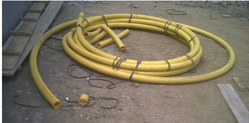
FIGURA 31: TUBERÍA DE POLIETILENO ALMACENADA A LA INTERPERIE
