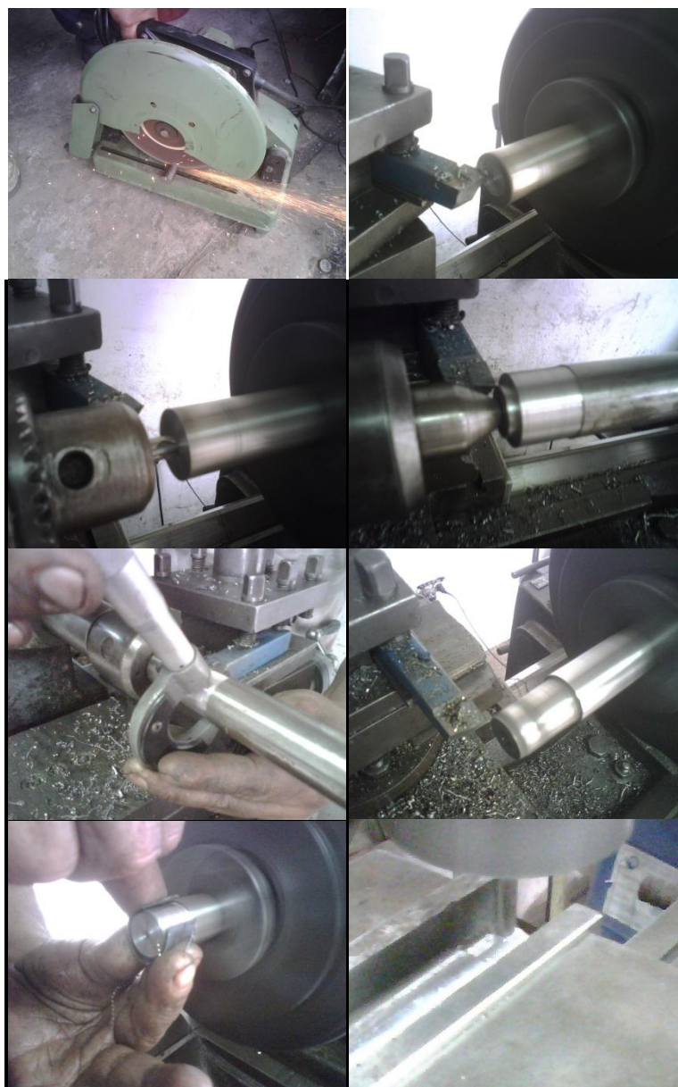
FIG. 2.3 PROCESO DE CONSTRUCCIÓN DE LOS EJES
