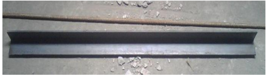
FIG. 2.9 FOTOGRAFÍA DE PERFILES ESTRUCTURALES EN BRUTO
