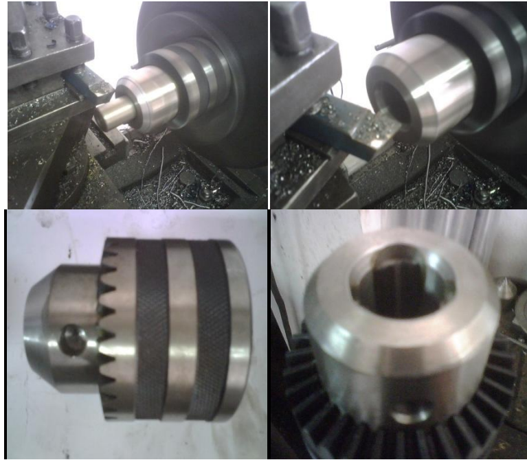
FIG. 2.8 PROCESO DE MECANIZADO DE LOS MANDRILES DE SUJECCIÓN
