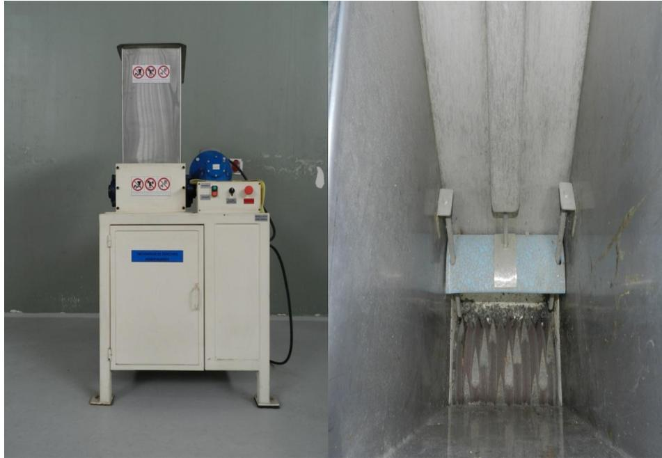
**FIGURA 3.10 TRITURADORA EN VISTA FRONTAL Y SUPERIOR**
