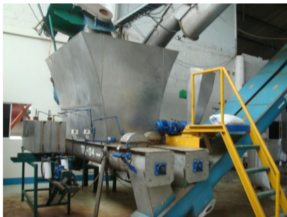
FIGURA 2.1 SISTEMA DE APLICACIÓN DEL AGENTE BACTERICIDA
