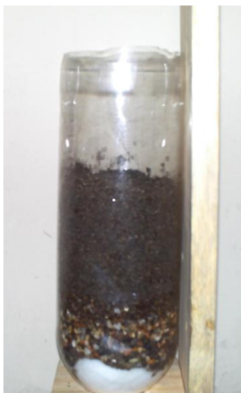
Figura 3.5 Filtro de Arena.
