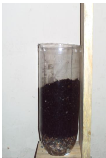
Figura 3.6 Filtro de Carbón Activado.
