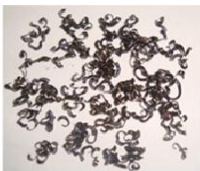
Figura 4.7. Formación de la viruta con la herramienta TNMG160404-PF GC4215 a distintas velocidades de corte
