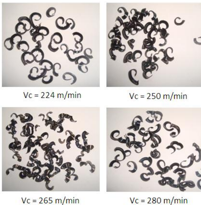
Figura 4.6. Formación de la viruta con la herramienta TNMG160408-PM GC4225 a distintas velocidades de corte
