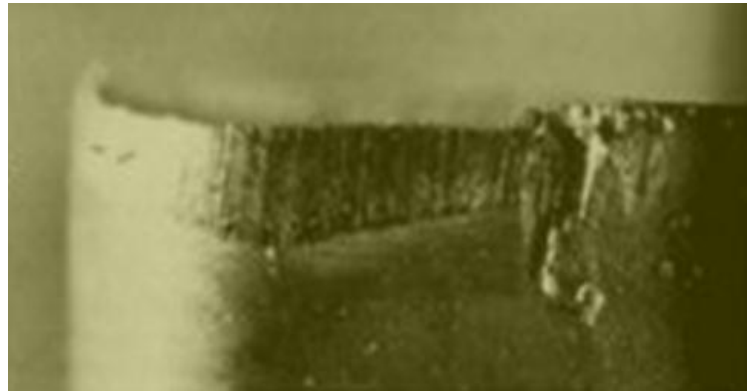
Figura 2.7 Desgaste en el flanco.
