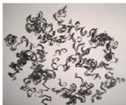
Figura 4.7. Formación de la viruta con la herramienta TNMG160404-PF GC4215 a distintas velocidades de corte
