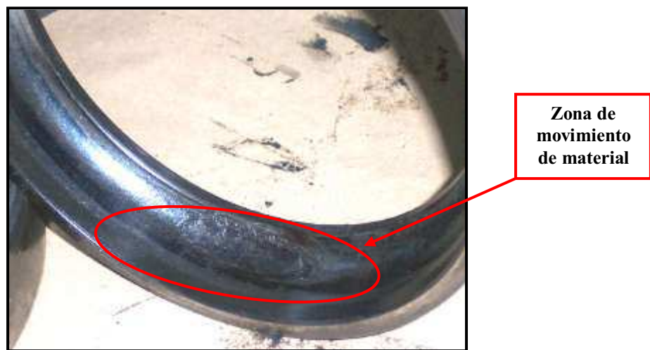
Figura 4.5 Pista exterior del rodamiento lado del acople.
