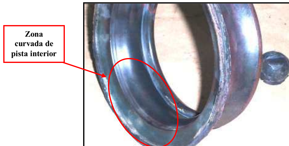
Figura 4.7 Pista interior curvada del rodamiento
