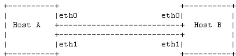
Figura 2.8: Conexión de Host a Host (duplica velocidad de transmisión)
