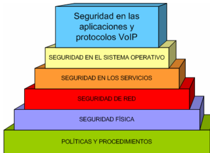
Figura 4.7. Arquitectura de Seguridad para Telefonía IP
