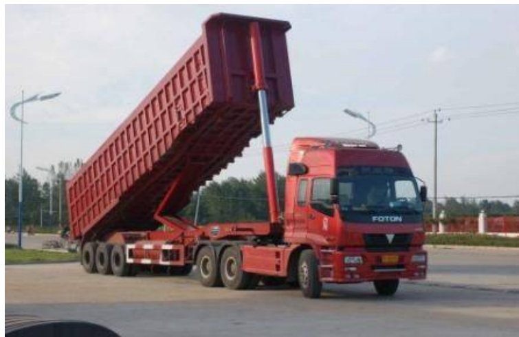
Figura 1.7. VOLQUETA TIPO BAÑERA
