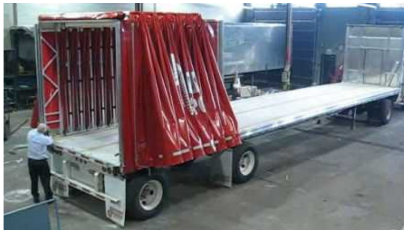
Figura 1.5. PLATAFORMA CON ENTOLDADO
