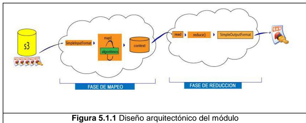
Figura 5.1.1 Diseño arquitectónico del módulo
