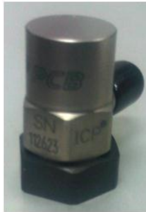
Figura 3.4 Acelerómetro PCB Piezoeléctrico Modelo 352C03
