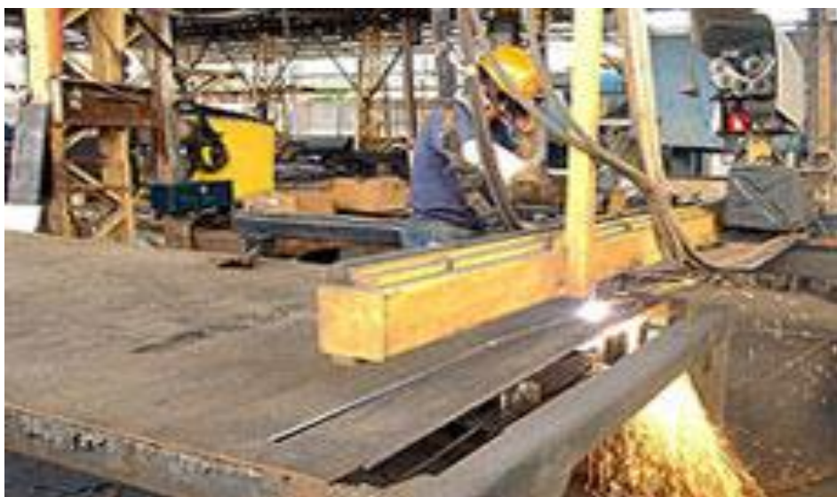
Figura 1.1.10. Corte por oxicorte con pantógrafo
