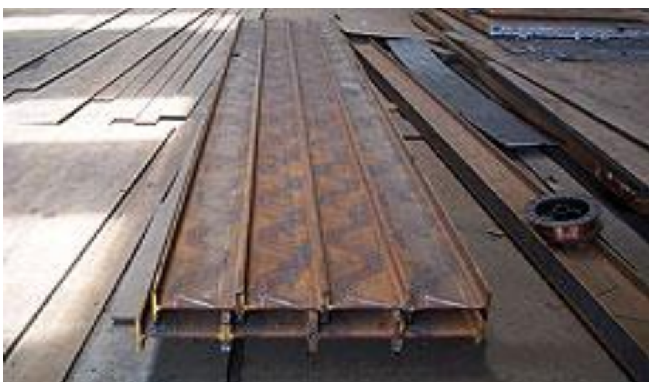
Figura 1.1.11. Corte de vigas boyler
