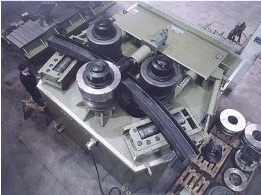
Figura 1.1.9. Curvado de una viga
