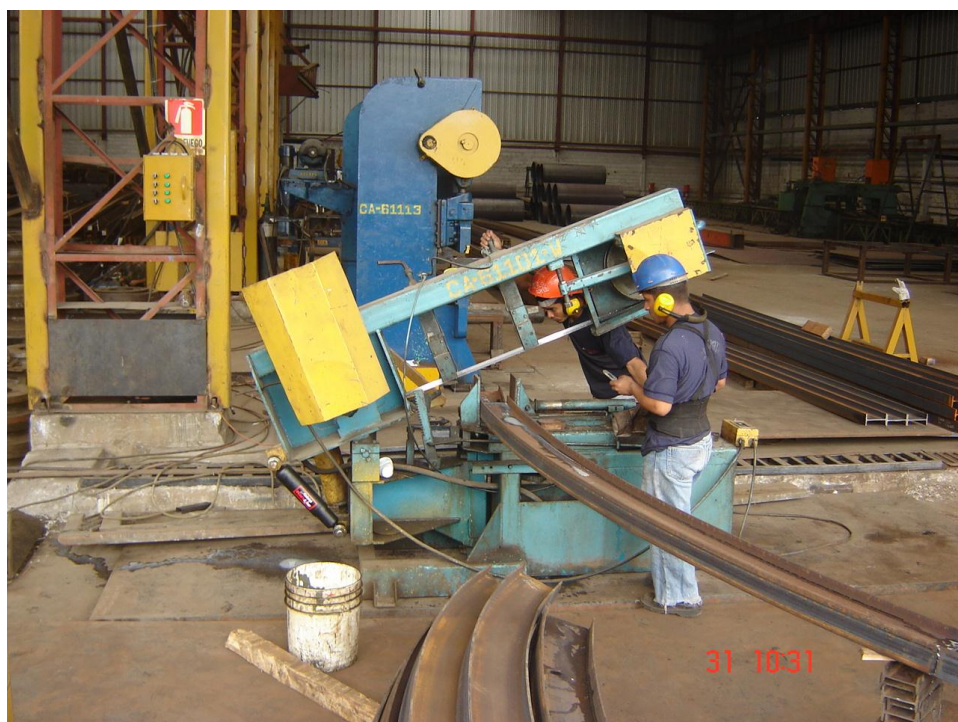
Figura 1.1.16 Corte por sierra de vigas
