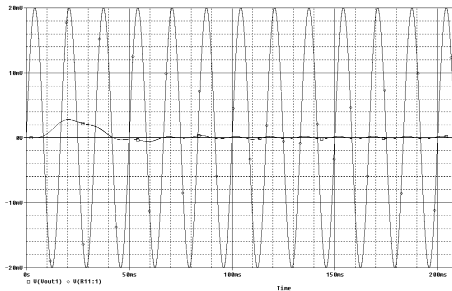
Figura 3.13 Atenuación del Ruido de 60 Hz del Filtro
