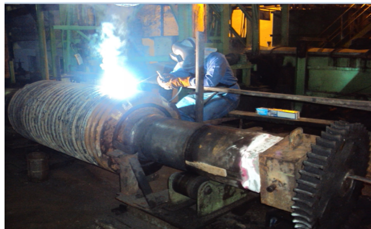
Figura 1.13 FOTOGRAFÍA DURANTE APLICACIÓN DE RECUBRIMIENTO
