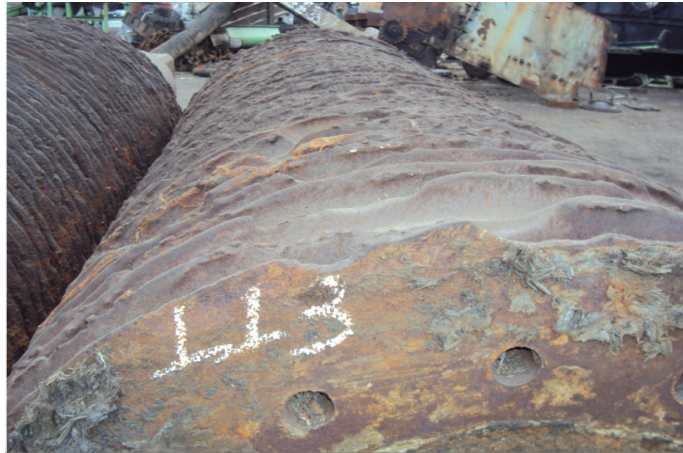
Figura 1.7 VISTA FRONTAL DE MAZAS DESGASTADAS
