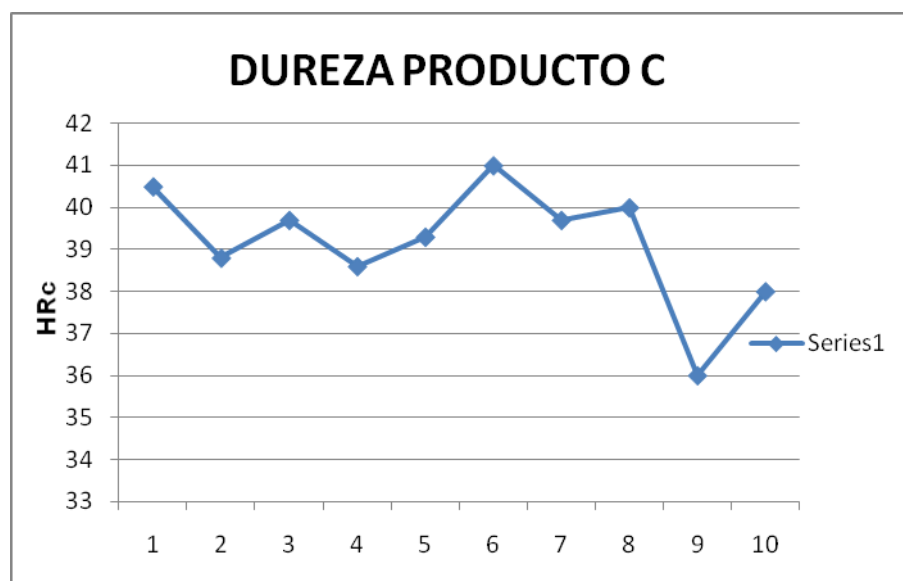
Figura 3.5 VARIACIÓN DE VALORES DE DUREZA EN PRODUCTO C
