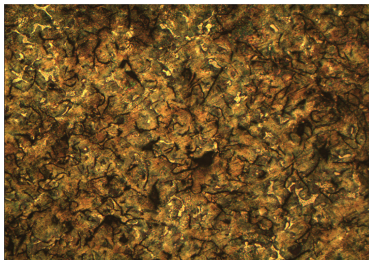
Figura 2.3 Material Base 100x Con Ataque
