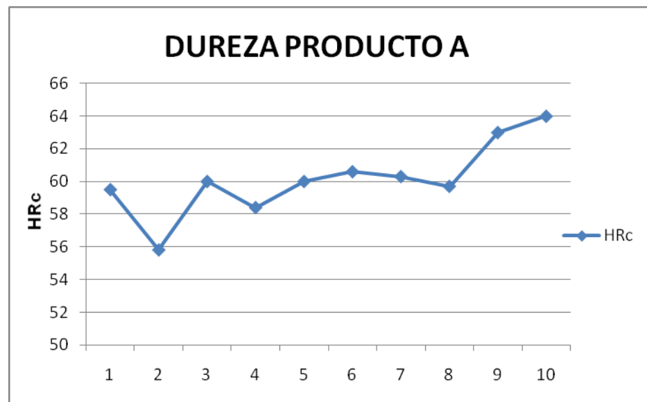
Figura 3.3 VARIACIÓN DE VALORES DE DUREZA EN PRODUCTO A
