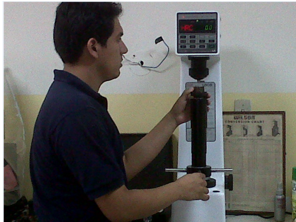
Figura 2.53 FOTOGRAFÍA DURANTE MEDICIÓN DUREZA
