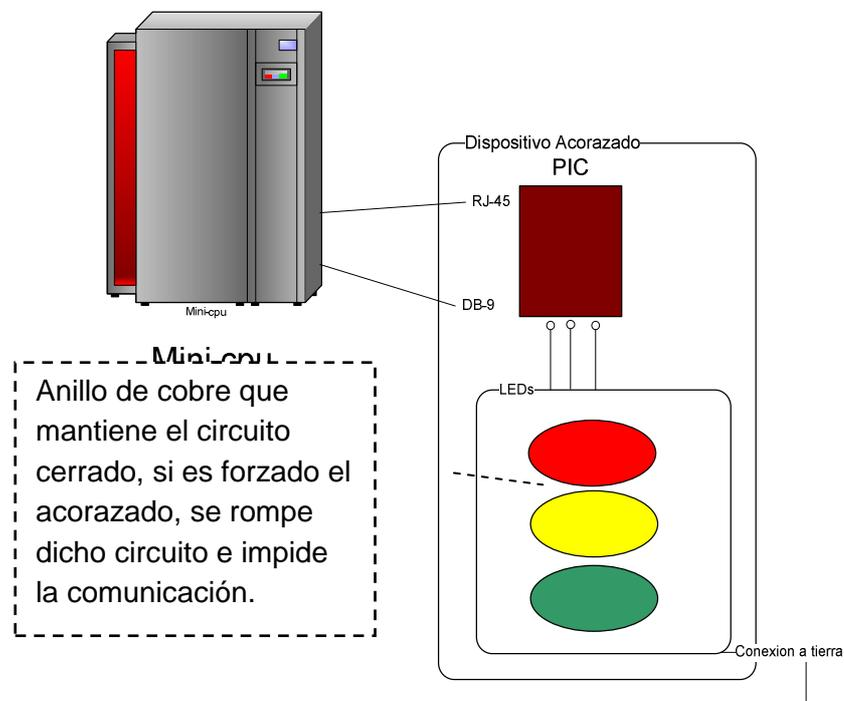
*Figura 10 Arquitectura del dispositivo acorazado*
