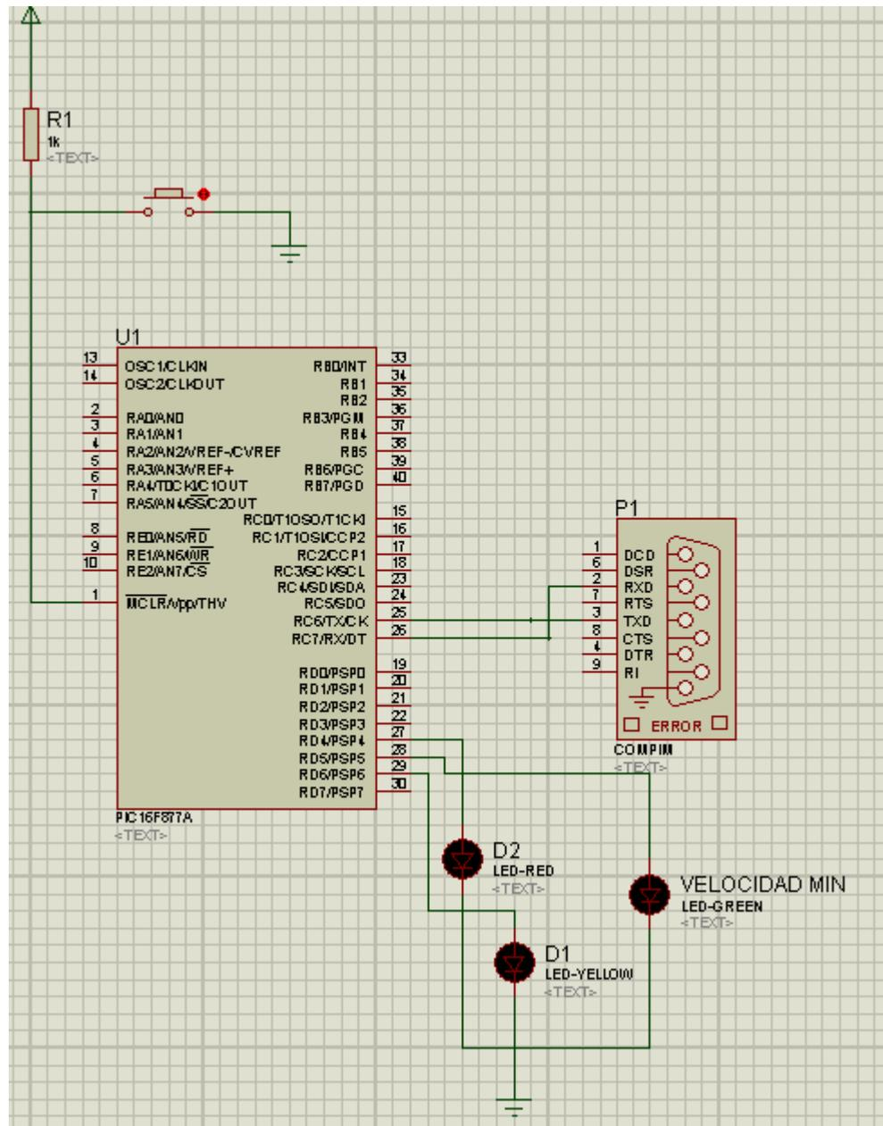
Figura 39 Simulación del circuito electrónico del Acorazado
