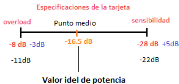
Figura 5.32 Cálculo del valor de potencia ideal para la tarjeta SLD4.
