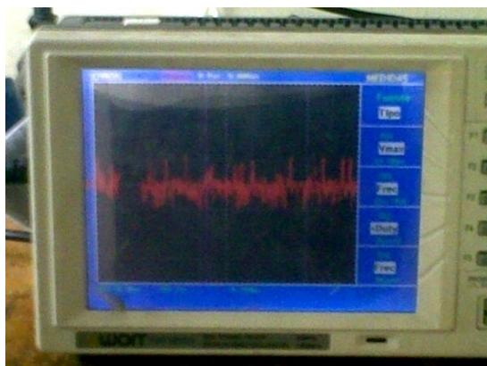
**Figura 4.2 Señal EMG en un osciloscopio**
