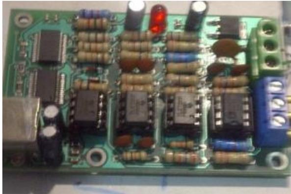
**Figura 3.6 Tarjeta EMG y Adquisición de datos**
