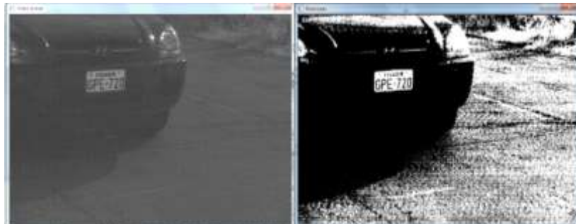
Figura 4-2: Muestra de imagen original y binaria
