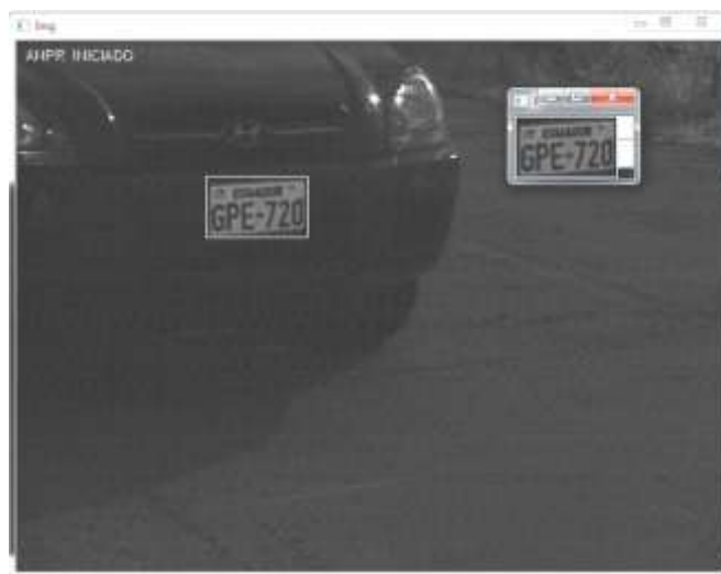
Figura 4-3: Muestra de la placa detectada
