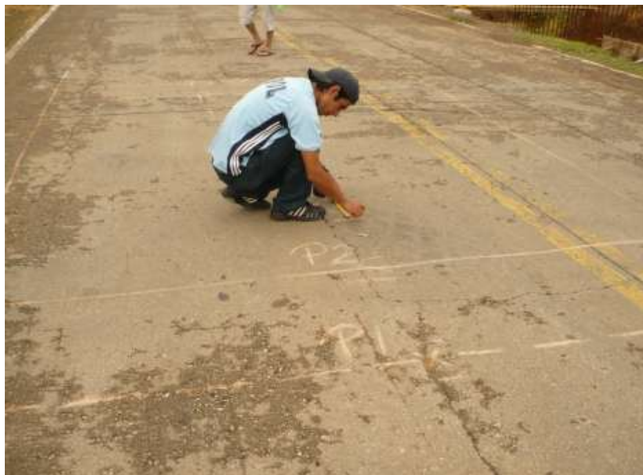
Figura 3-21: Especificar los puntos de prueba
