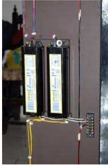
Figura 2.7 Balastro magnético (carga que produce armónicos)
