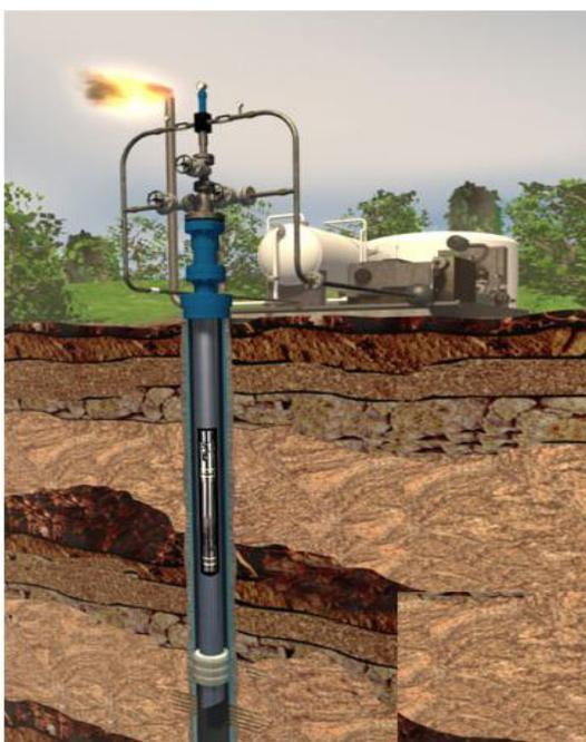
**Figura 3-6:** Representación grafica del Sistema de bombeo hidráulico.
