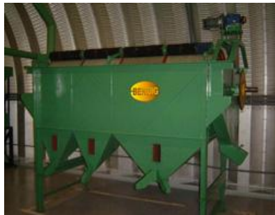
Clasificadora por tamaño, Forma y peso del café
