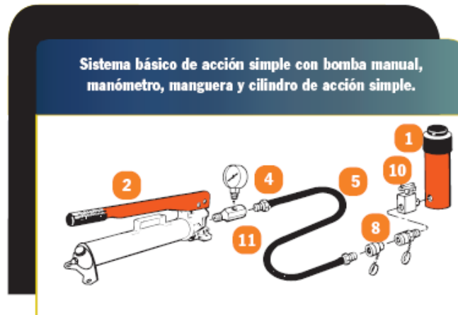
Figura 4-36 SISTEMA DE ACCIÓN SIMPLE
