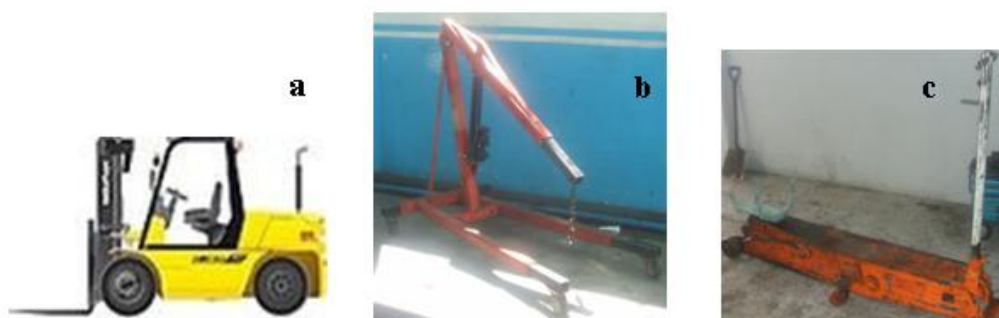
Figura 2-1 a. MONTACARGAS b. TECLES. c. GATOS ADAPTADOS A LA APLICACIÓN
