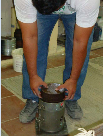
Fotografía 17.- CBR: Colocando Base.
