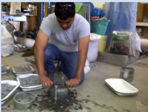
Fotografía 19.- CBR: Nivelación con la regla.
