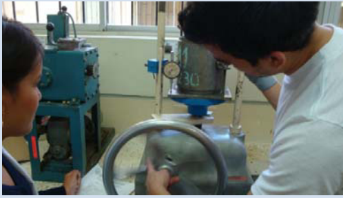
Fotografía 21.- CBR: Ajustando la muestra a la prensa de anillo.
