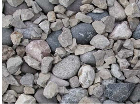
Figura 1-7.- Agregados Gruesos (Grava)
