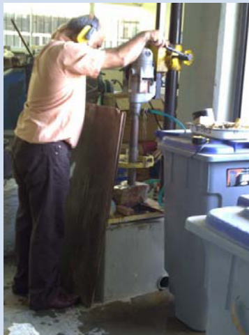
Fotografía 25.- Resistencia: Extrayendo el Núcleo.
