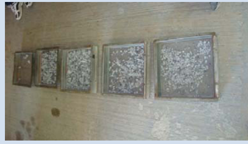
Fotografía 6.- Granulometría: Tamices con agregados retenidos después del tamizado.
