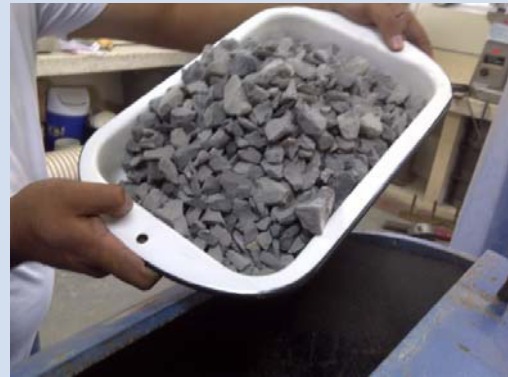
Fotografía 12.- Abrasión de los Ángeles: Colocación de los agregados al tambor.
