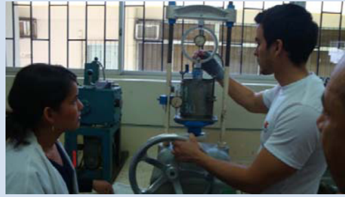
Fotografía 22.- CBR: La muestra está instalada, el anillo y su dial de deformaciones, el dial mide las deformaciones.
