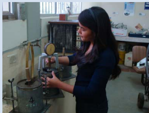
Fotografía 20.- CBR: Calibrando el trípode dial de expansión, junto con la placa de expansión.
