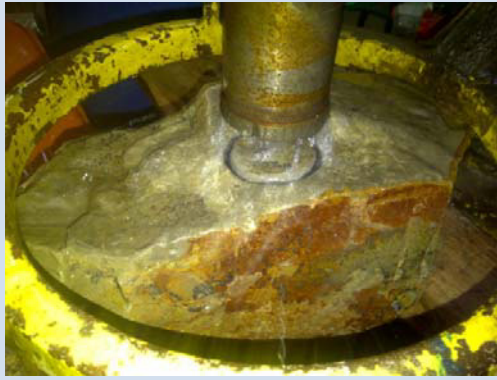
Fotografía 27.- Resistencia: Extrayendo el Núcleo.
