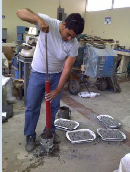
Fotografía 15.- Proctor Modificado: Golpes por capa (50)
