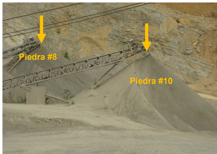
Figura 4-8.- Almacenamiento de la piedra #8 y piedra #10
