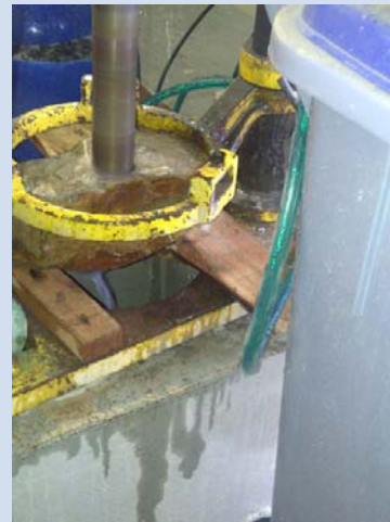
Fotografía 26.- Resistencia: Extrayendo el Núcleo.
