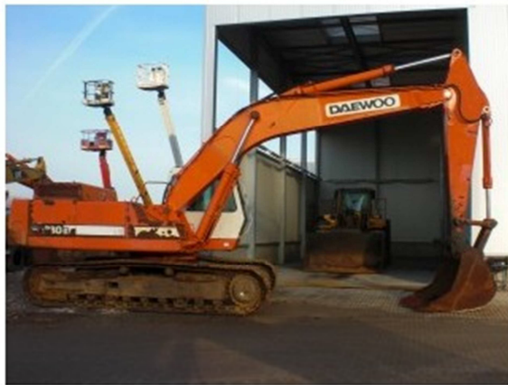
Figura 3-8.- Excavadora de Oruga DAEWOO 330 SL-%
