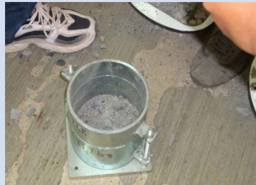
Fotografía 14.- Proctor Modificado: Colocación de los agregados en el molde.
