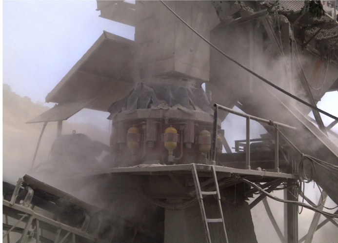
Figura 4-2.- Trituradora de Cono de la cantera San Luis
