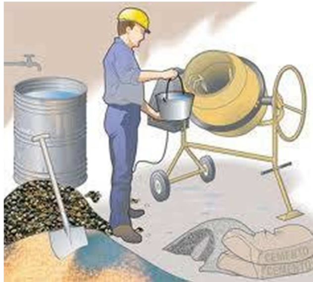
Figura 6-2.- Mezcla de las componentes del hormigón, entre ellos los agregados.
