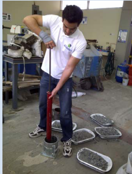
Fotografía 18.- CBR: Golpes por capa, aumento contenido de agua.
