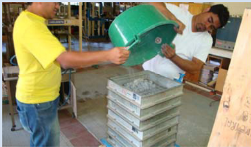
Fotografía 5.- Granulometría: Colocación del agregado en el tamizador.
