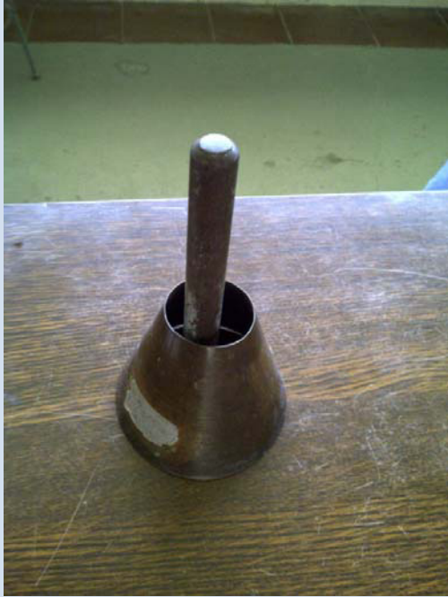
Fotografía 9.- Densidad y Absorción Agregado fino: Molde Cónico
