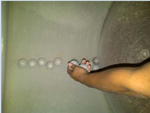
Fotografía 11.- Abrasión de los Ángeles: Esferas del ensayo.
