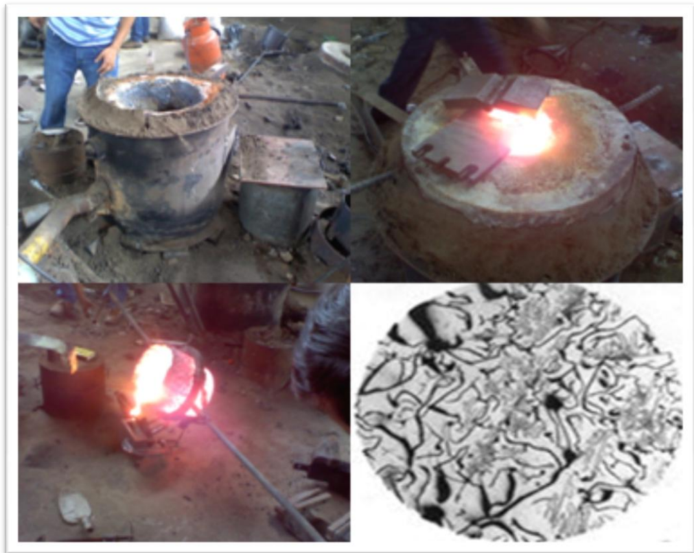
FIGURA 2.26. PROCESO DE OBTENCIÓN DE ACERO ASTM A48 (FUNDICIÓN GRIS) Y MICROESTRUCTURA Cojinetes de Fricción
