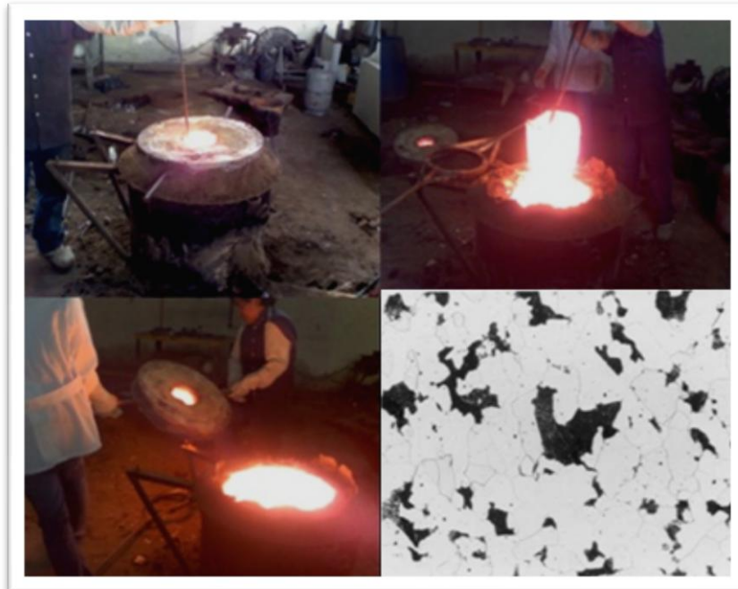
FIGURA 2.25 PROCESO DE OBTENCIÓN DEL ACERO SAE 1020 Y MICRO ESTRUCTURA
