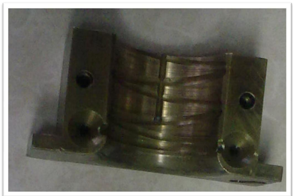
FIGURA 1.3. COJINETE DE DESLIZAMIENTO CON ROSCAS DEFORMADAS.
