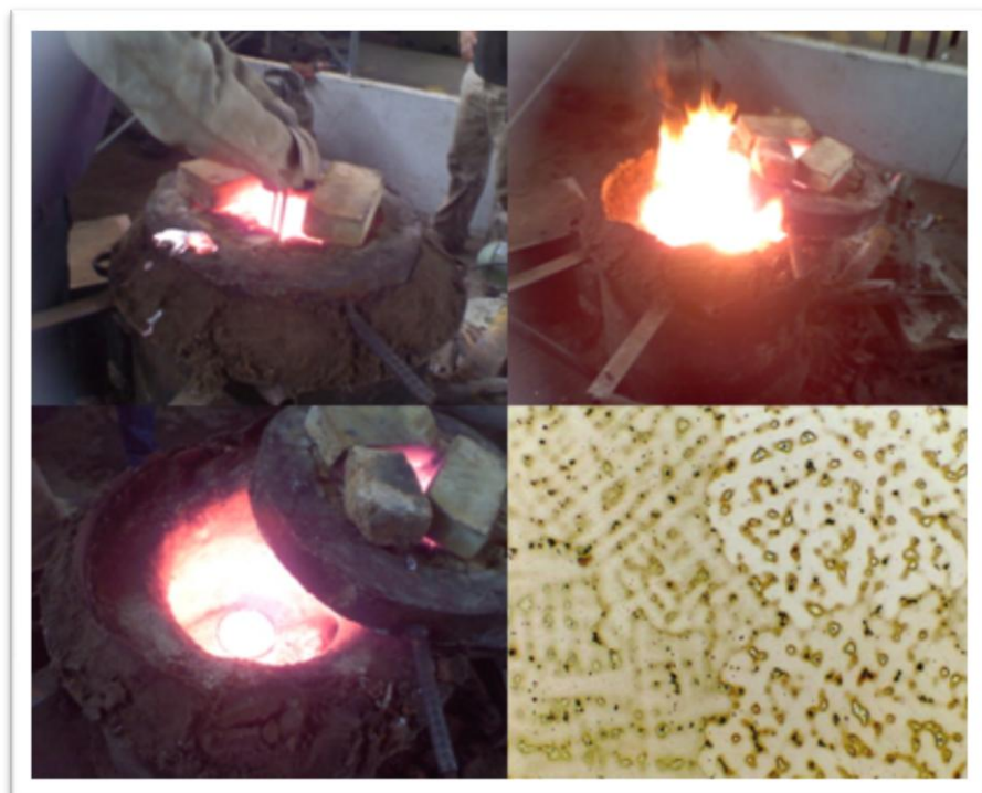
FIGURA 2.27. PROCESO DE OBTENCIÓN DEL BRONCE B271 Y MICROESTRUCTURA
