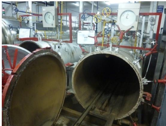
Fig. 2.14: Autoclave de vapor saturado
