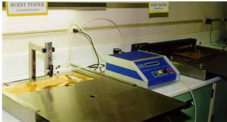
Fig. 2.6: Equipo para prueba de presión interna
