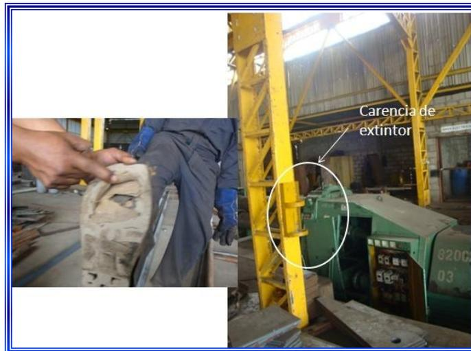
**FIGURA 2.14: FALTA DE SEGURIDAD INDUSTRIAL**
