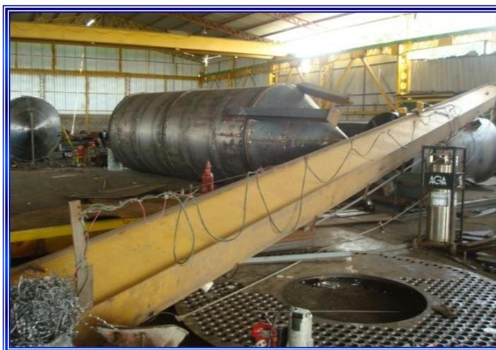
**FIGURA 2.13: CAÍDA DE PUENTE GRÚA DE 5 TON.**
