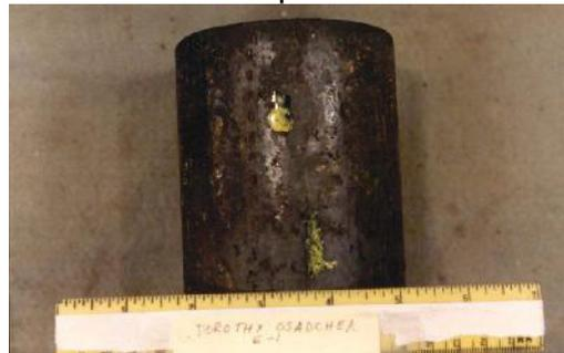
El hidrógeno quebradizo es una falla en los materiales metálicos quebradizos a diversos niveles de esfuerzos o rendimiento, que da como resultado a la exposición del átomo de hidrogeno.
