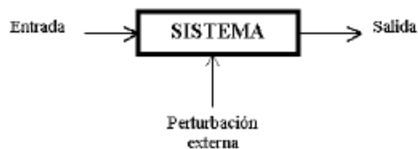
Figura 2.7 Diagrama de bloque básico de un control en un sistema
