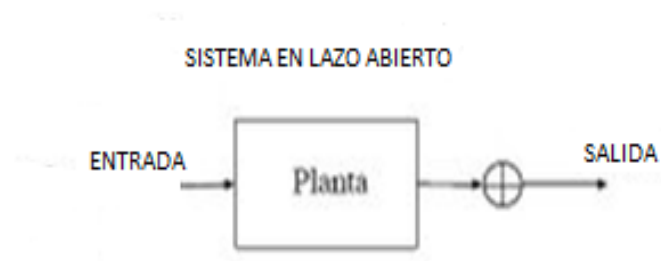
Figura 2.3 Diagrama de bloques de un control en lazo abierto
