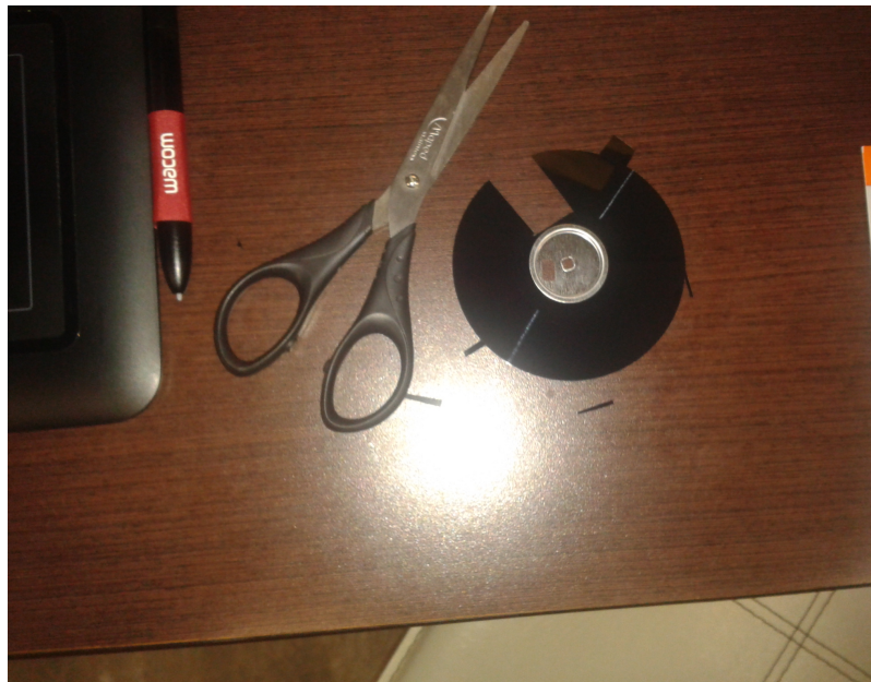
Figura 65: Lámina interna en forma de disco, obtenida dentro de un diskette
