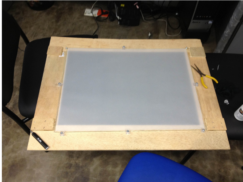
Figura 61: Instalación de la plancha de acrílico junto al papel plano en el marco de madera
