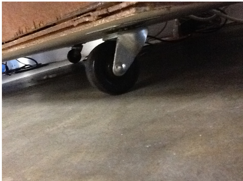
Figura 59: Ruedas en la parte inferior de la estructura
