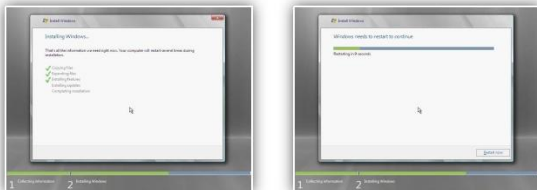
Ilustración 23. Instalación de componentes y reinicio de la instalación
