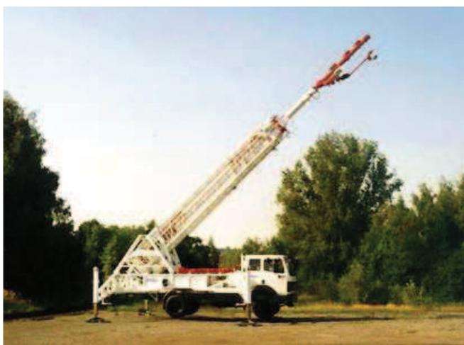
**FIGURA 1.9 GRÚA-TORRE SOBRE CAMIÓN**
