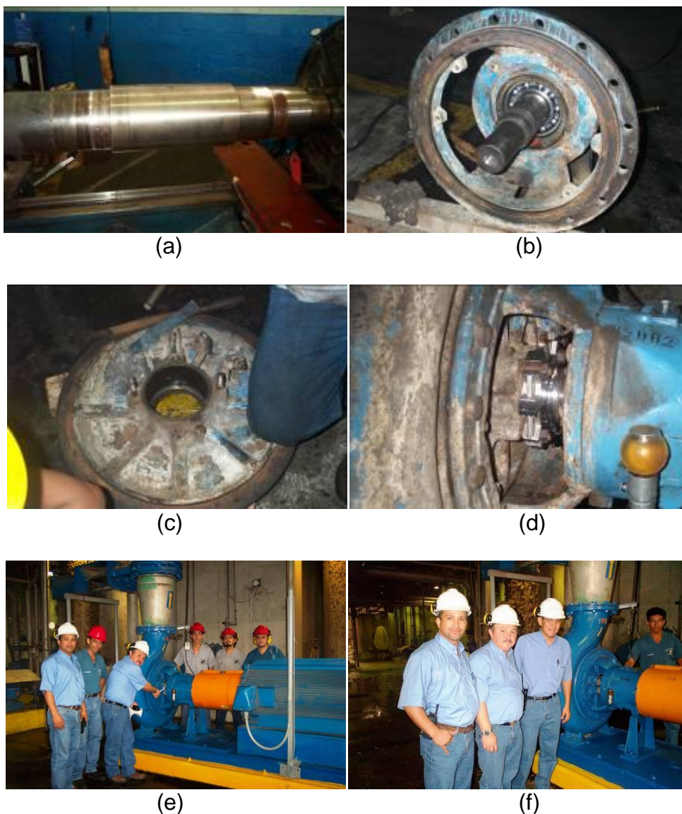
Figura N° 2.6: Proceso de mejora bomba limpiadores primarios posiflow P15.
