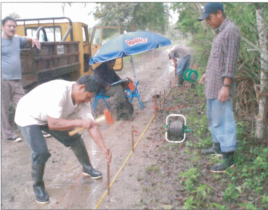
Fig. 4.5.- Realización de SEV en Olón.
