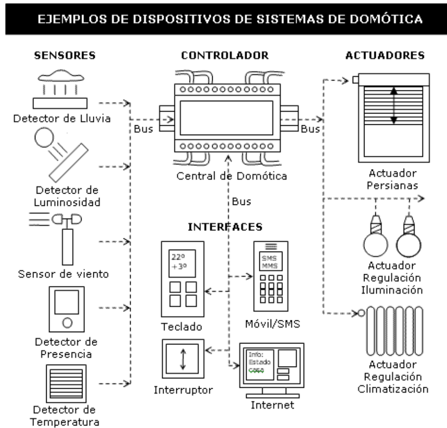
Figura 5.- Dispositivos de un sistema domótico
