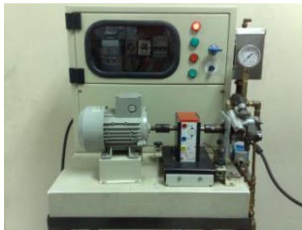
Figura 3.55 Planta de Control de Velocidad
