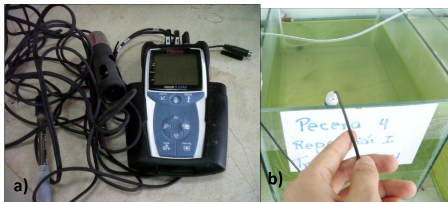
Fig. 13. a) Potenciómetro y b) Medición de parámetros en cada una de las peceras. Por Cristina Jines
